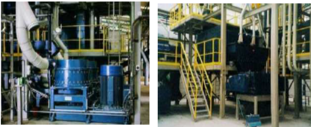
Figura N° 8: Molienda y tamizado en la planta.
