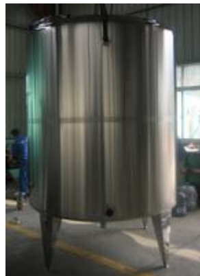
Gáfico 46.- Tanque elevado de acero inoxidable
