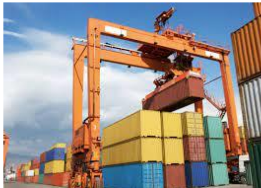
Figura 42 Grúa RTG Rubber Tyred o grúa pórtico sobre neumáticos
