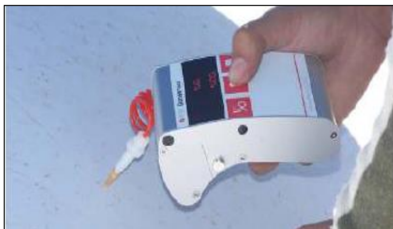
Figura 12. MUESTREO DEL NIVEL DE O 2 Y CO 2 CON UN MEDIDOR PORTÁTIL DE GASES.
