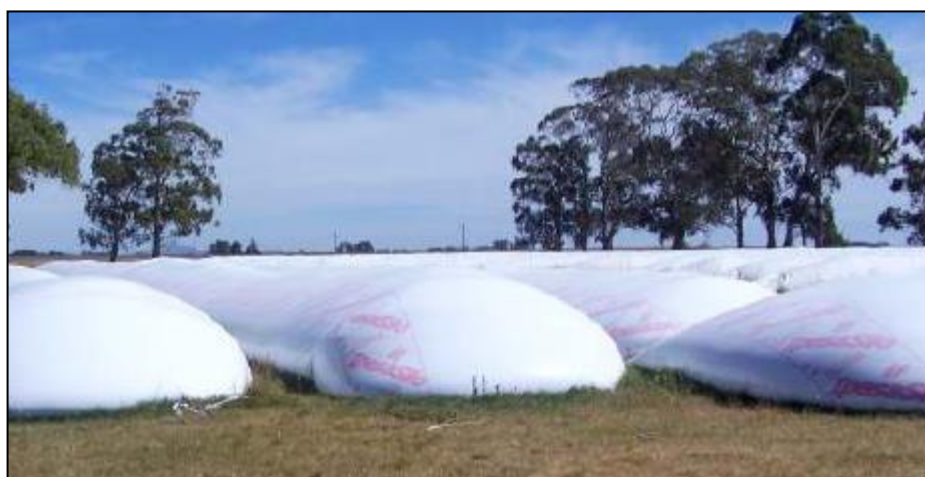
Figura 8. BOLSAS PLÁSTICAS HERMÉTICAS DE ALMACENAMIENTO DE 200 TONELADAS DE CAPACIDAD (75 m largo y 2,76 m diámetro).
