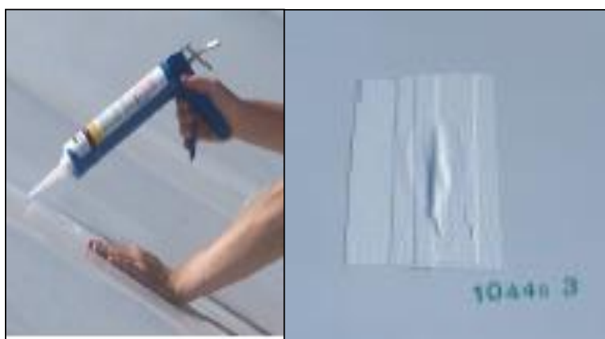
Figura 14. SELLADO DE LA SILO BOLSA
